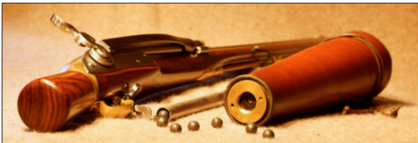
Børse med trykktanken avmontert. I midten ligg magasinet for kulene.
